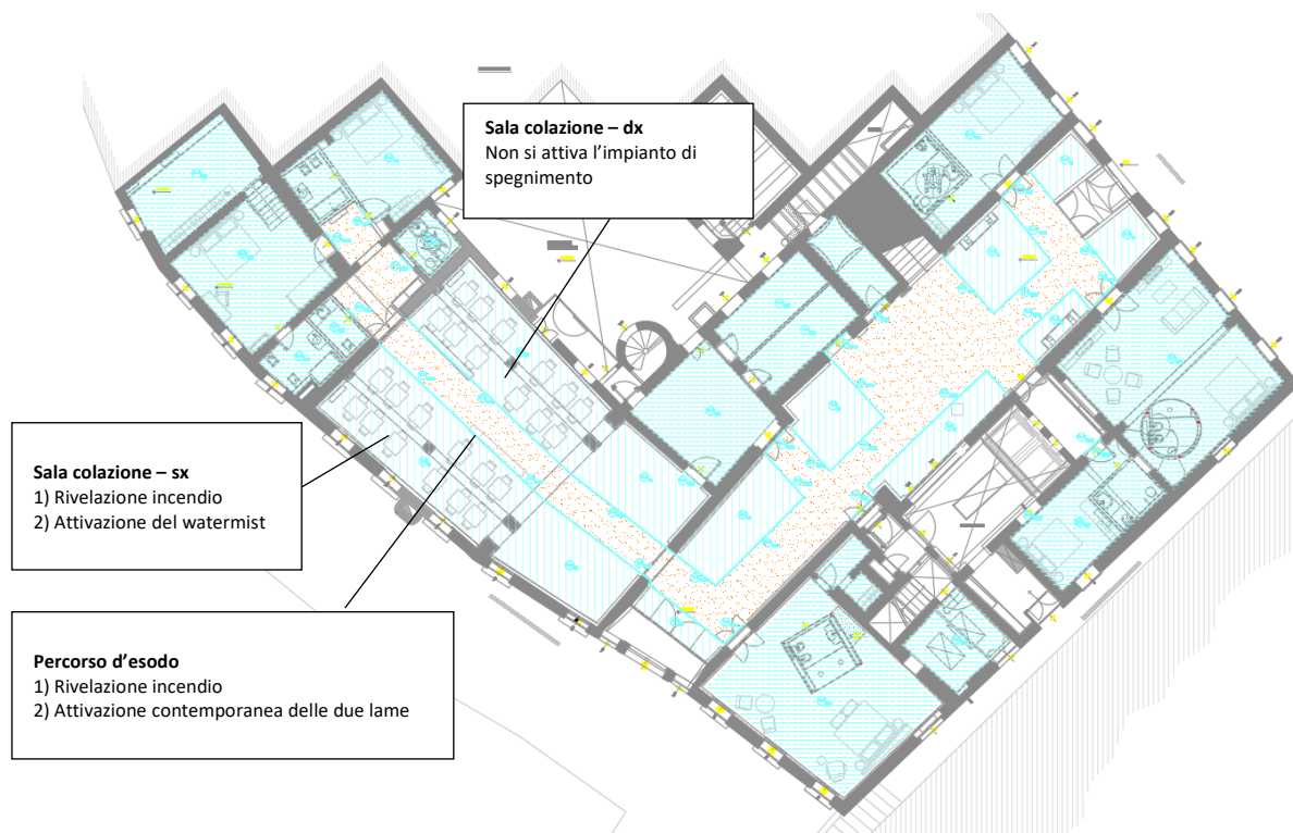
Figura 6– Schema delle differenti tipologie di impianto di spegnimento watermist
