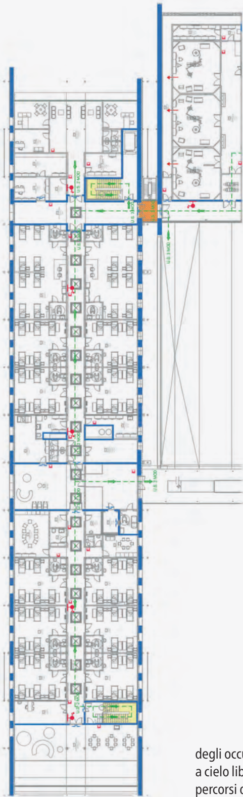
Tavola 1 | Stralcio Planimetria piano primo con indicazioni compartimentazioni e misure antincendio
