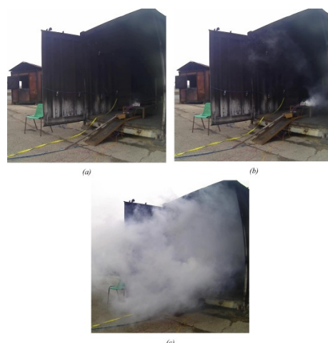
Figura 4. Abuso meccanico di un modulo di batterie al litio cariche al 50% State of Charge (SOC). La nube di gas prodotta conteneva HF, CO 2 , CO, H 2 , e HCN [2]. Riprodotto con permesso da [2].
