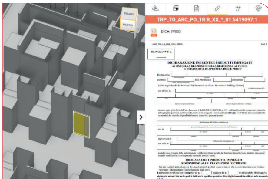
Figura 3 | Collegamento certificazioni ad elemento costruttivo
