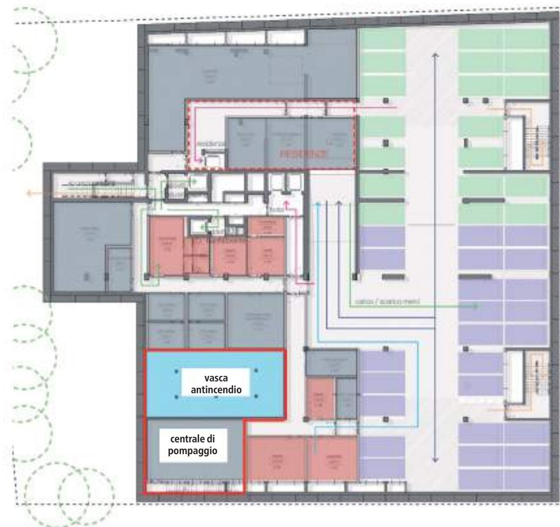
Figura 5 | Piano S1 – Individuazione vasca antincendio e centrale di pompaggio
