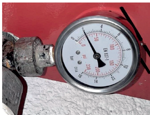
Figura 3 | Esempio Verifica funzionale: Prova di pressione in esercizio Impianto Idrico antincendio
